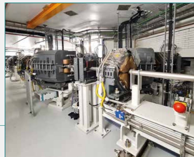
Strålerøret leder protonerne fra acceleratoren og ud til behandlingsrummene. Magneter afbøjer strålen og fokuserer den. Foto: Dansk Center for Partikelterapi
