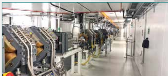
Protonerne bliver accelereret op til 2/3 af lysets hastighed inden de føres ud i strålerøret, der løber bag behandlingsrummene.
